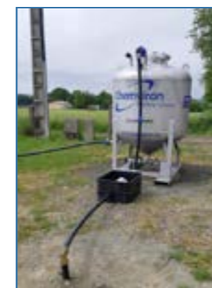
Filtre provisoire à charbon actif pour essais—Champsac
